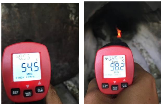
ภาพที่ 5 อุณหภูมิบริเวณห้องเผาไหม้และห้องหมัก
