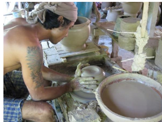
ภาพที่ 8 การทดลองขึ้นรูปผลิตภัณฑ์ด้วยแป้นหมุนของชุมชน (บ้านนางจำเป็น รัชเมือง)
