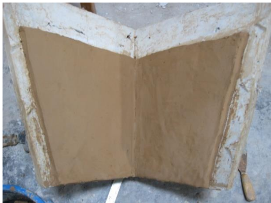
ภาพที่ 11 การทดลองขึ้นรูปผลิตภัณฑ์ด้วยการอัดแม่พิมพ์ด้วยดินจากการทดลอง
