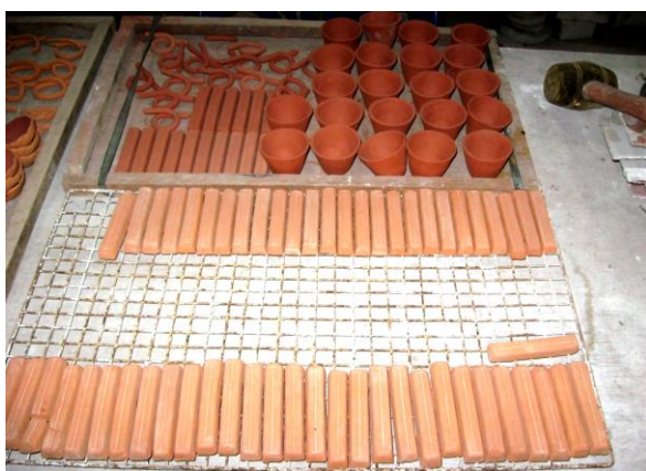
ภาพที่ 14 ตัวอย่างแผ่นทดลองหาอัตราส่วนผสมและทดสอบทางกายภาพของดินปั้น ชุด A
