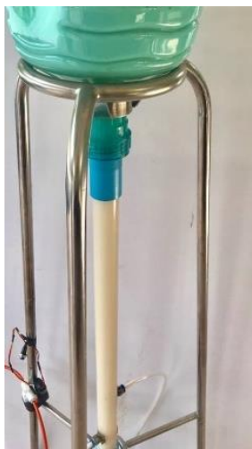
(ค) ถังหมักและการประกอบอุปกรณ์หมักและแยกน้ำมันมะพร้าว
