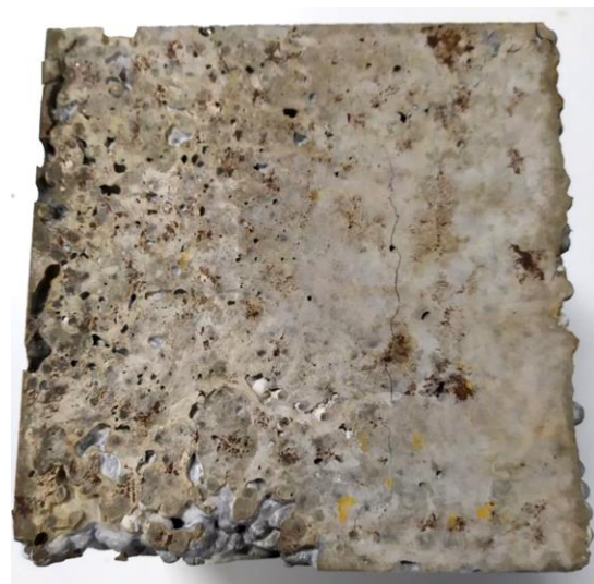
ภาพที่ 3 ลักษณะการพบัติจากการทดสอบกำลังอัด
