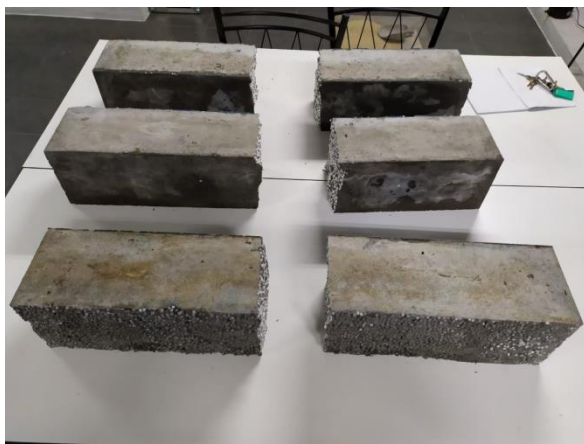
ภาพที่ 4 ลักษณะการพิบัติจากกำลังดัด
