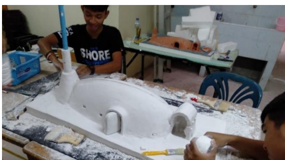
ภาพที่ 12 การสร้างต้นแบบ (Model) โครงสร้างของเตาเผาไฟต่ำเพื่อวิเคราะห์และประเมินความคิดเห็นโครงสร้าง
